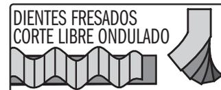
Para cortes precisos en metales delgados y gruesos, tubos, perfiles abiertos y cerrados.
