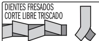
Para cortes rápidos en madera blanda/dura, aluminio, plástico, metales ferrosos y no ferrosos.
