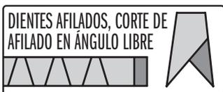
Para cortes simples en madera gruesa y de construcción, madera contrachapada y plástico.
