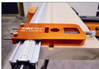
Para ranuras mayores del diámetro de la fresadora, es necesario simplemente ajustar el tornillo y ampliar el hueco.
