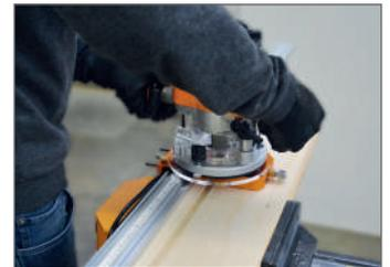
Deslizar suavemente la fresadora mediante la guía de **PGD-1**. El resultado es un corte perfectamente lineal, limpio y sin defectos.
