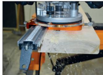
Verificar la profundidad de corte y punto de comienzo del fresado, utilizando los tres enrrases que indican donde empiezan las ranuras, para los diámetros más comunes (12-10-8mm en la parte frontal y, 1/2"-3/8"-1/4" en la parte trasera).
