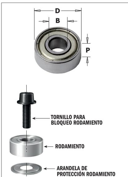
**RECOMENDACIONES DE SEGURIDAD:** Al cambiar los rodamientos tenga mucho cuidado con el sentido y colocación de la arandela de protección del rodamiento. La misma no debe nunca tomar contacto con el anillo exterior del rodamiento ya que se aflojaría.
