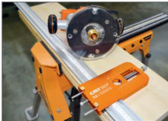
Montar el anillo en la base y fijarla a la fresadora. Posicionar la abrazadera sobre la pieza de trabajo y el **PGD-1**, regulando los tornillos roscados para vincular la tuerca a la abrazadera
